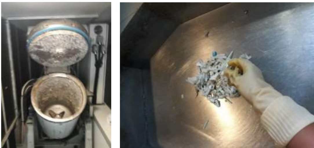
Gambar 3-25 Autoclaf dan Residu Hasil Pengolahan
