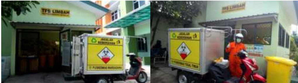
Gambar 3-12 Alat Angkut Roda Tiga untuk Pengangkutan Limbah B3 dari Puskemas ke RSUD Kardinah
